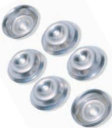
1/4" 碟型爆破片是上节所示爆破片安装座的组件。爆破片的最低压力应当不小于系统工作压力的110%。爆破片的标准材质为不锈钢材质。爆破片在室温68°F时的压力范围如下表所示。我们还可以根据客户需求定制其它材质和压力等级的爆破片。
